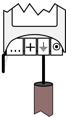
Las sondas de medida de este dispositivo son del tipo [DS18B20](#), su alimentación es de 3,3V y se comunican con el equipo a través de un único cable, en la imagen puede ver una de las sondas que suministramos con el dispositivo.
